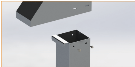
Fixieren des Deckels am FDD mit mitgeliefertem Schraubensatz
