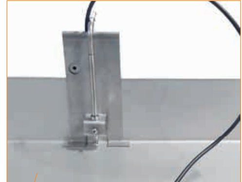
GES-Sensor – je nach Anforderung Oberes Bild: Innenwandig montiert
